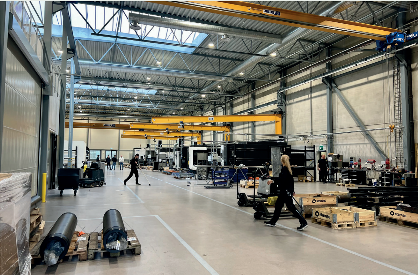
Kombinasjonsbygget har 10 + kraner, som blant annet sparer ansatte for å løfte inn i maskinene.
