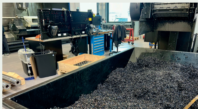
Produksjonen med omfattende dreining gir mye stålspån. Gulvene i kontordelen tåler tråkk av sko med stålspån i sålene.
